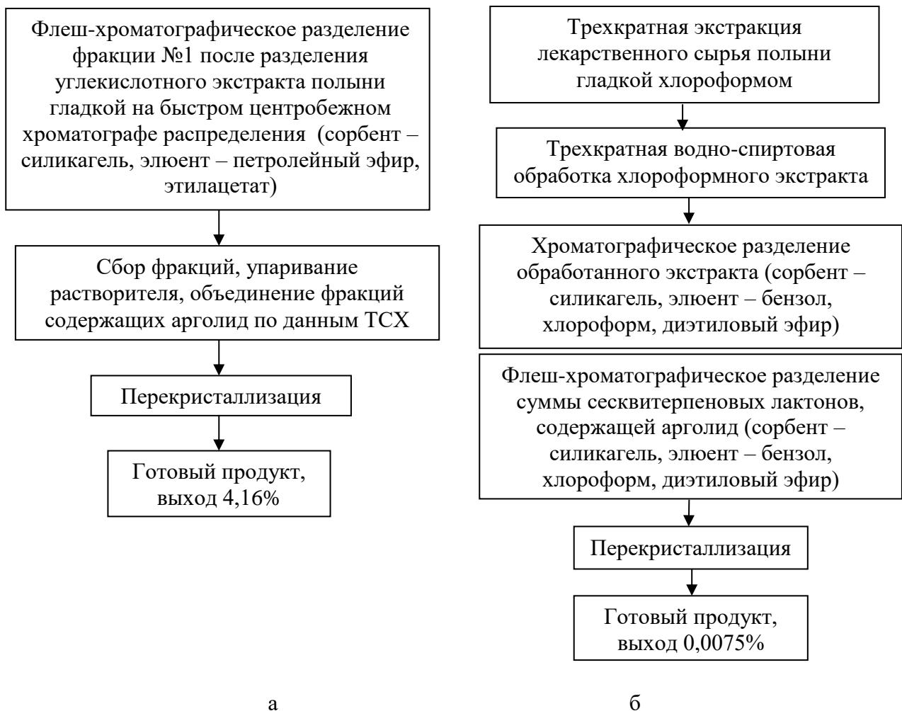
а – получения арголида на основе комплексной переработки углекислотного экстракта полыни гладкой; б – выделения арголида из лекарственного сырья полыни гладкой
