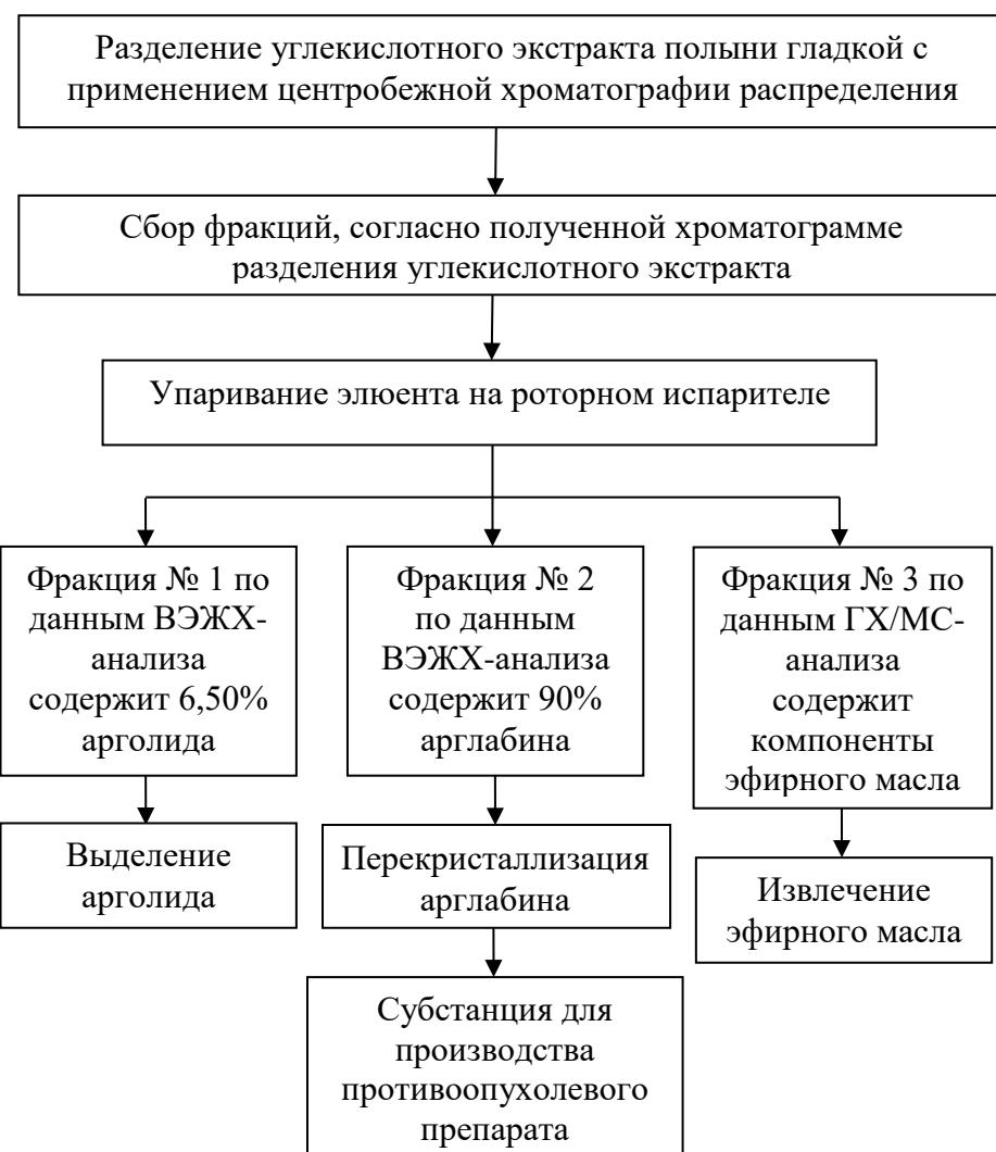
Рисунок 1 – Блок-схема комплексной переработки углекислотного экстракта полыни гладкой
