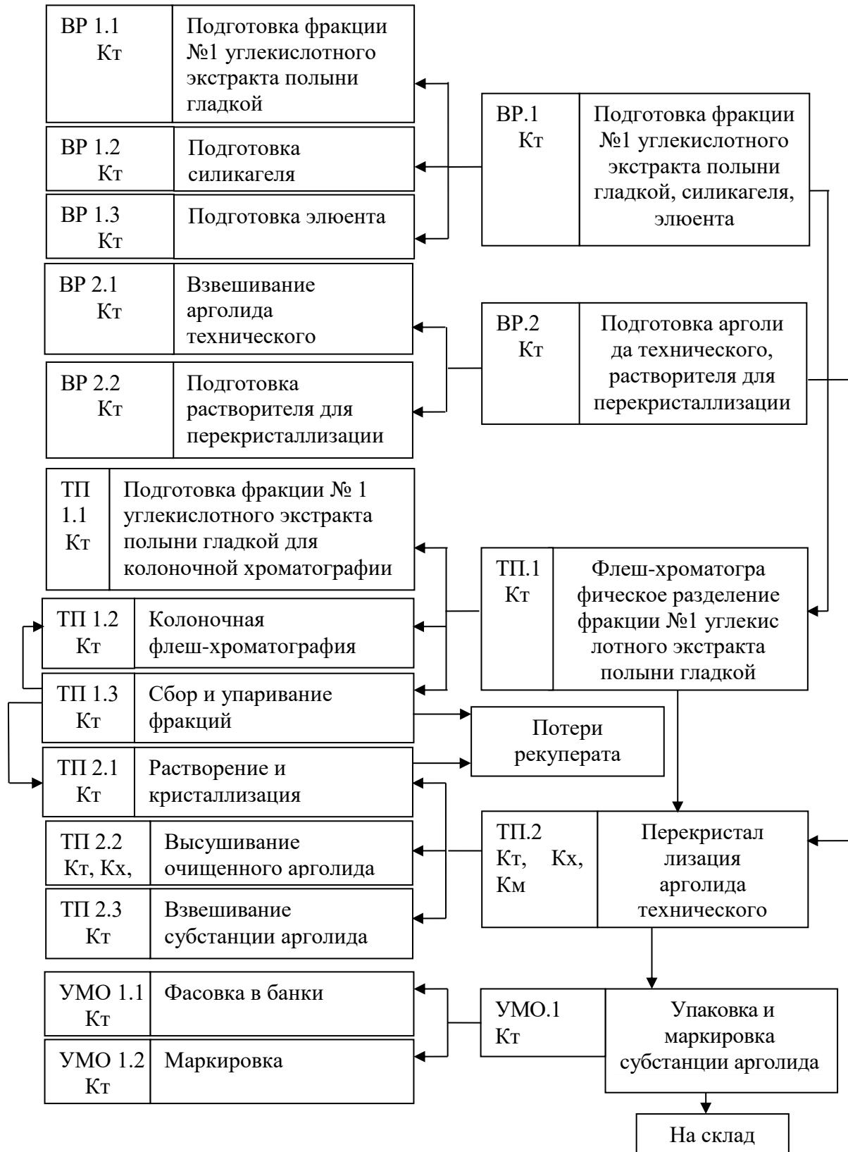
Кт – контроль технологический; Км – контроль микробиологический; Кх – контроль химический
